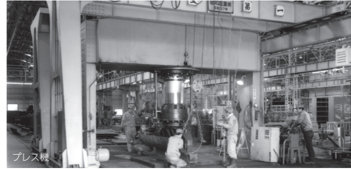
熱間加工中の鏡板(第1棟)
