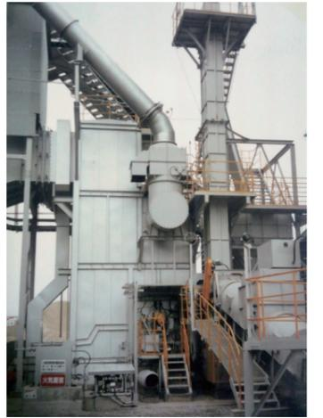
FG-10型熱風炉
