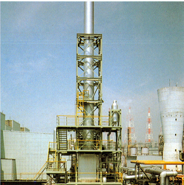
写真 5 : 某鉄鋼会社 WEF-1500 型 10\text{T}/\text{H} \times 10\text{kg}/\text{cm}^2 \times 4000\text{kW} \times 1 基
